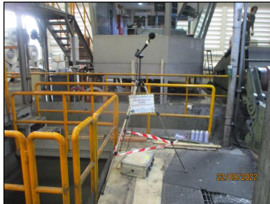
รูปที่ 3.11 การตรวจวัดระดับเสียงในพื้นที่ทำงาน ( L_{eq} 8 hr.) บริเวณ Cold Mill Area
