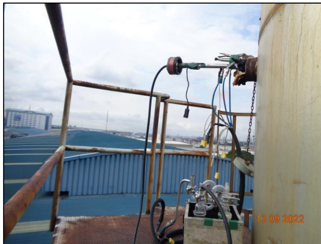
รูปที่ 3.1 การเก็บตัวอย่างคุณภาพอากาศในปล่องระบาย บริเวณ ปล่องควันของเตาหลอม
